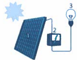
1. Zonnepaneel | 2. Omvormer | 3. Elektrische toestellen
